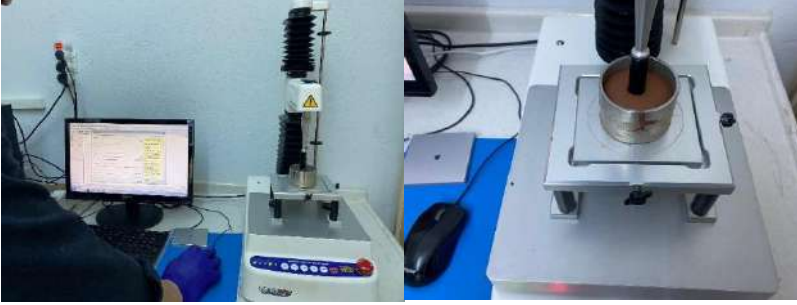
Şekil 8, 9. 3B basıma uygun kil kıvamının saptanması için TPA cihazında kilin test edilmesi. (Fotoğraf: S.Ünal)
