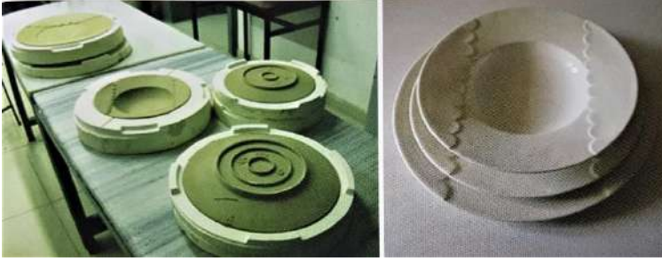
Şekil 6. İşlemler sonucunda CNC'de elde edilen alçı kalıplarla, çekirdek dökümden üretilmiş pişirim öncesi ürünler (solda), üretilen seramik tabakların sırlı pişirim sonrası görüntüsü (Güner ve Ödekan, 2018: 89)
