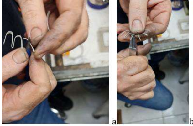
Fotoğraf 14a.b. Telin Şekillendirilmesi, Tarak.
