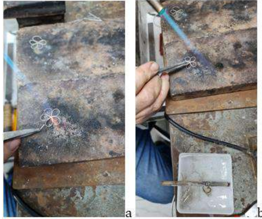
Fotoğraf 16a.b. Kaynak İşlemi, Teneker.
